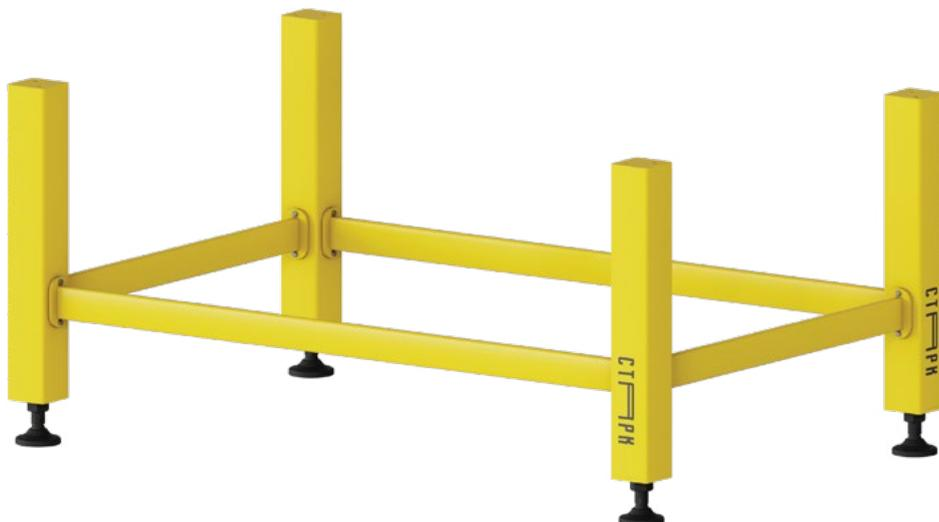
Стандартная опора выпускается в нескольких вариантах высоты (нестандартные размеры по запросу) Обладает несущей способностью 2,000 кг и точной регулировкой высоты в пределах 50 мм. Опорный пятак позволяет сгладить неровности пола. Опора защищена руковом, что позволяет защитить резьбовое соединение от грязи и недопускает повреждение кабелей, которые может возникнуть из-за постоянного контакта с резьбой
