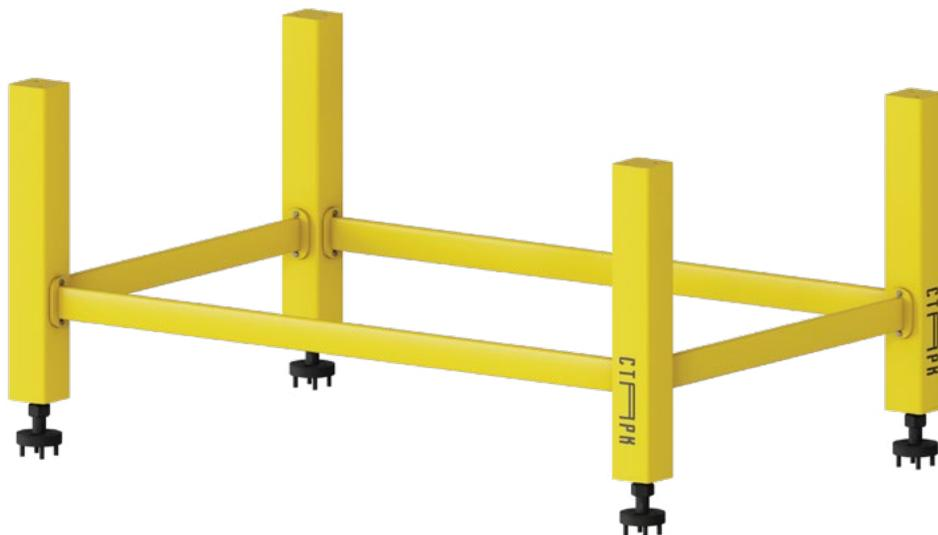
Опора с креплением к полу выпускается в нескольких вариантах высоты (нестандартные размеры по запросу) Обладает несущей способностью 2,000 кг и точной регулировкой высоты в пределах 50 мм. Опорный пятак позволяет сгладить неровности пола. Опора защищена рукавом, что позволяет защитить резьбовое соединение от грязи и не допускает повреждение кабелей, которые может возникнуть из-за постоянного контакта с резьбой.
