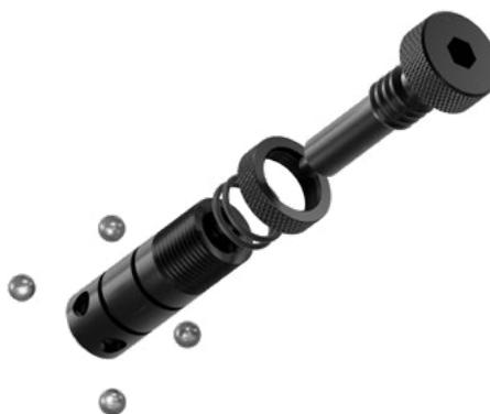
Благодаря стопорным кольцам болт сам центрируется и фиксируется в системе отверстий, при закручивании болта шток выталкивает шарики и происходит фиксация элементов. Благодаря кольцу регулировки удобен для зажима элементов разной толщины. При высоком усилии зажима предотвращается смещение элементов в сторону.
