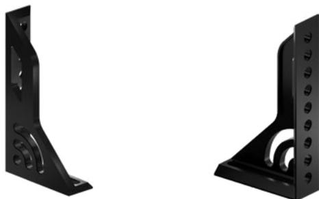
Упорный и крепежный угольник L500 поворотный используется в качестве упора, подходит для работы с другими угольниками. Путем фиксации через слот возможно формирование регулируемой по высоте поверхности. Часто используется для увеличения рабочей поверхности стола. Благодаря радиусным отверстиям слотам позволяет соединять элементы оснастки под любым углом в диапазоне 90°.
