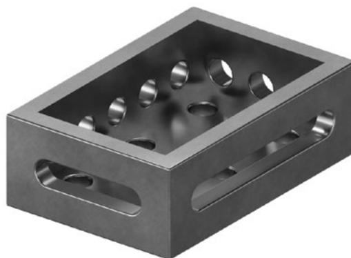
Блок расширения 300x200x100 соединяет разные элементы, используется для увеличения рабочей поверхности или служит консолью. Благодаря наличию системы отверстий шагом 50 мм и отверстий слотов, можно использовать фиксированные и регулируемые упоры.
