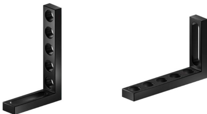
Упорный и крепежный угольник L275 с 5-ю отверстиями используется в качестве упора, а также для расширения рабочей поверхности. Путем фиксации через слот возможно формирование регулируемой по высоте поверхности.
