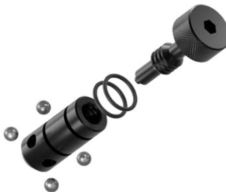
Благодаря стопорным кольцам болт сам центрируется и фиксируется в системе отверстий, при закручивании болта шток выталкивает шарики и происходит фиксация элементов. При высоком усилии зажима предотвращается смещение элементов в сторону.
