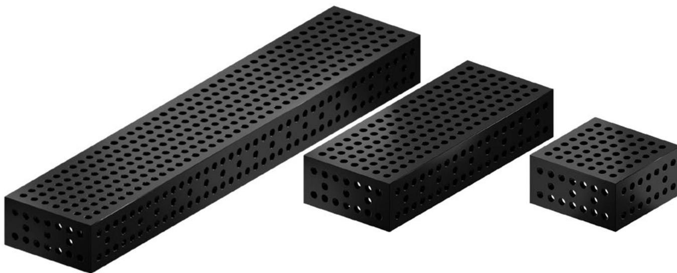
Блок расширения 400/200 имеет горизонтальное / вертикальное расположение отверстий на основной рабочей поверхности и параллельно расположенные отверстия шагом 50 мм на боковых стенках. Диаметр отверстий составляет 28 мм. Блок выполнен из 24,5-27 мм плиты высокого качества, сталь S355J2+N.
