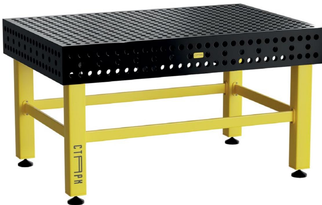
Профессиональный сварочно-монтажный стол имеет горизонтальное / вертикальное расположение отверстий на основной рабочей поверхности и параллельно расположенные отверстия шагом 50 мм на боковых стенках. Диаметр отверстий составляет 28 мм.
