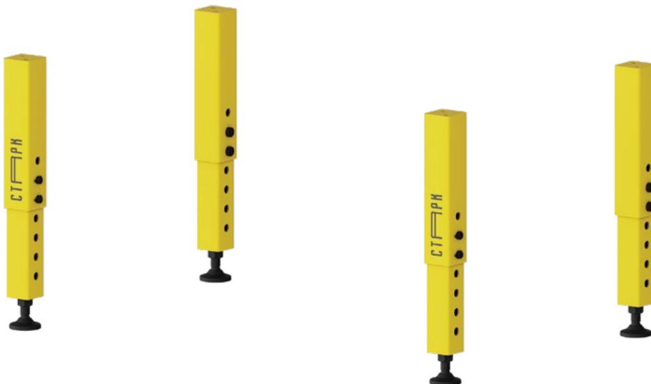
Телескопическая опора регулируется от 550 до 900 мм (нестандартные размеры по запросу) Обладает несущей способностью 800кг и точной регулировкой высоты в пределах 50 мм. Опорный пятак позволяет сгладить неровности пола. Опора защищена рукавом, что позволяет защитить резьбовое соединение от грязи и не допускает повреждение кабелей, которые может возникнуть из-за постоянного контакта с резьбой.
