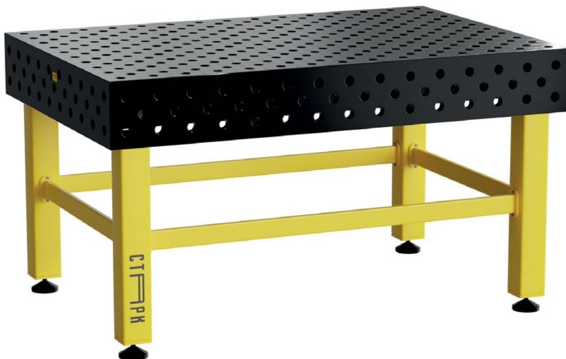
Профессиональный сварочно-монтажный стол имеет горизонтальное / вертикальное расположение отверстий на основной рабочей поверхности и параллельно расположенные отверстия с шагом 50 мм на боковых стенках. Диаметр отверстий составляет 28 мм.
